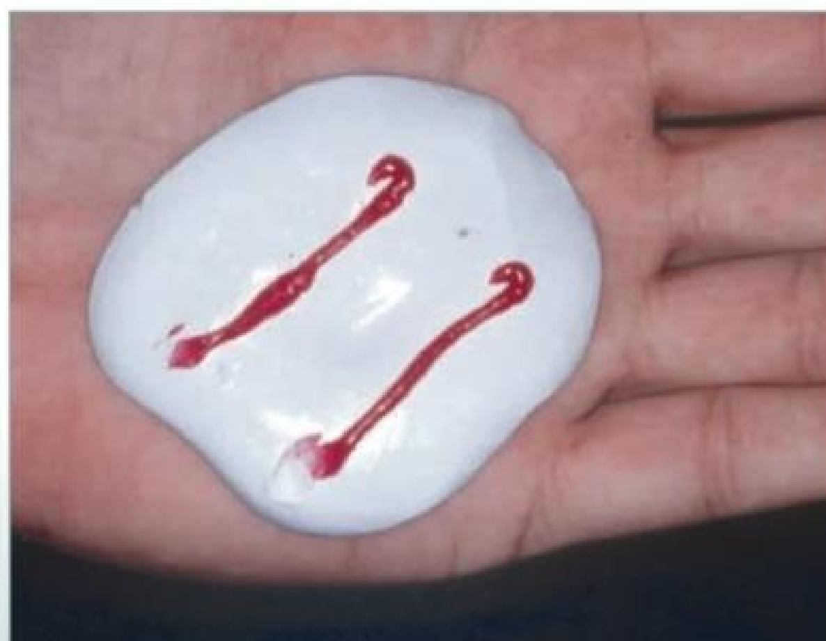
Fig. 20-17. Deve-se despejar o catalisador sobre o silicone.
