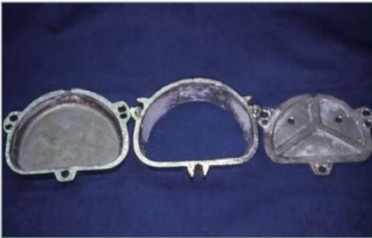
Fig. 20-1. Mufla para polimerização em água, desmontada, mostrando da esquerda para a direita mufla propriamente dita, contramufla e tampa.
