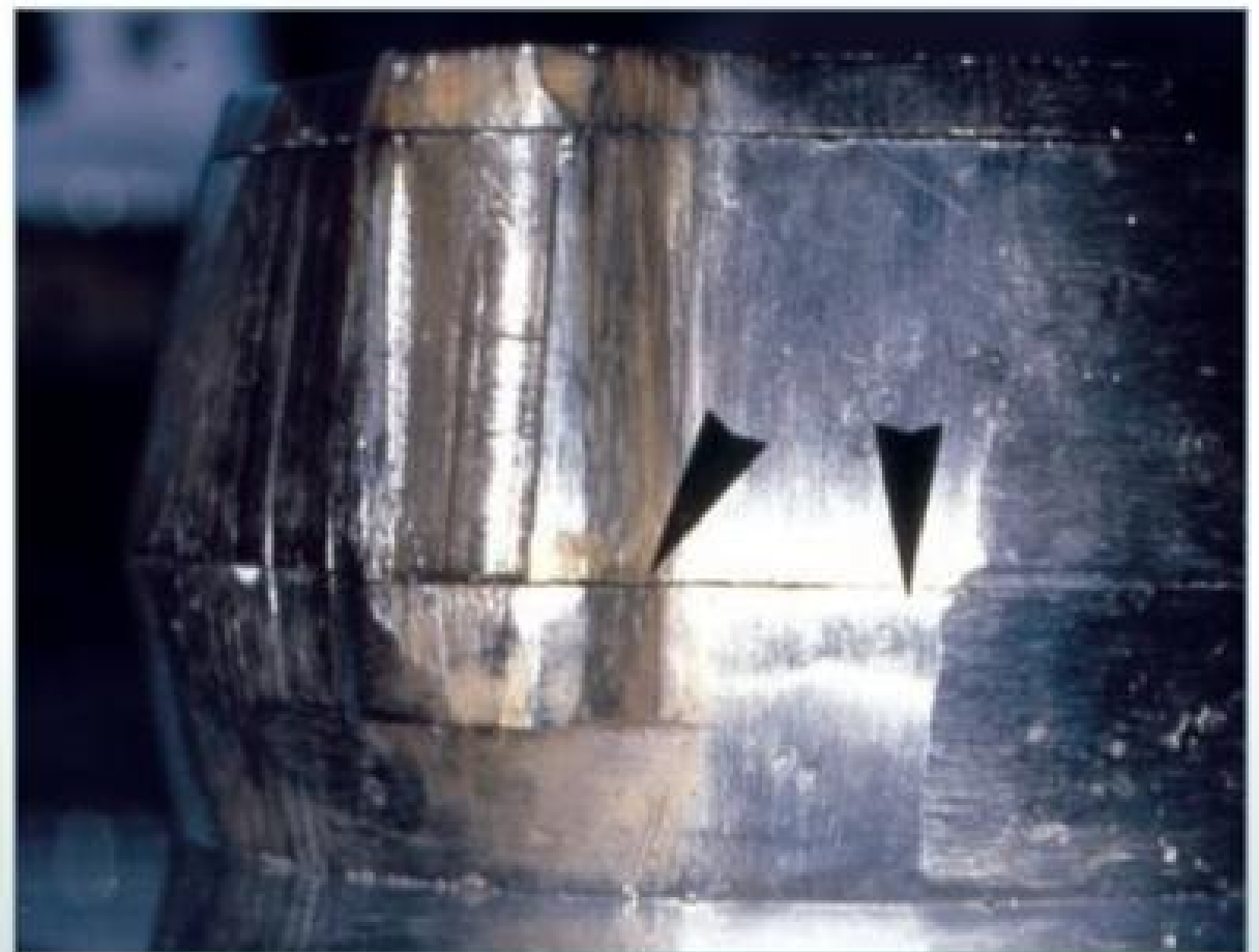
Fig. 20-4. Mufla fechada para água, onde as setas indicam o encaixe e a borda, que devem ser bem justas para evitar qualquer movimento horizontal.
