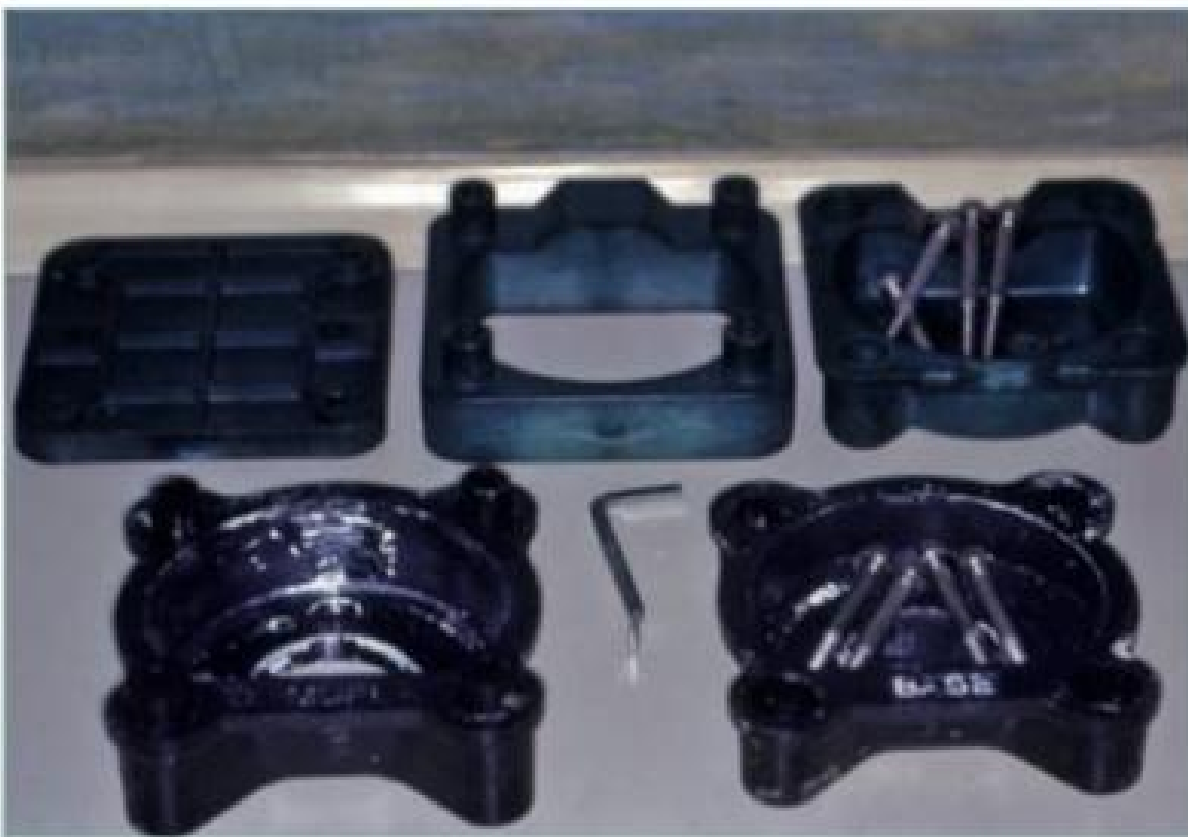
Fig. 20-2. Muflas para micro-ondas (com parafusos). Ao alto, mufla da Clássico, abaixo, mufla da Vip, esta se divide em apenas duas partes, possuindo um orifício na contramufla para vazamento do gesso.
