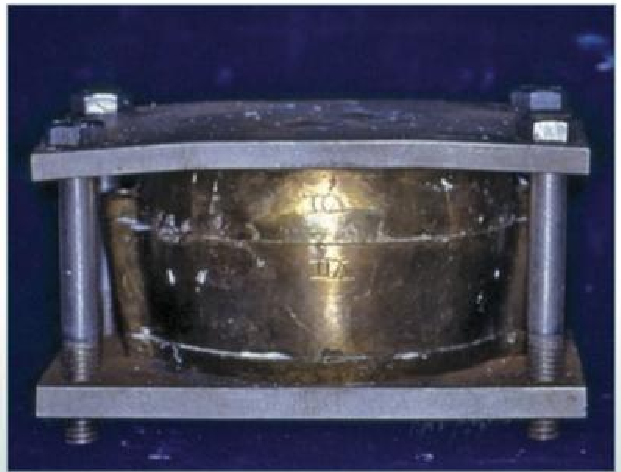
Fig. 20-3. Placa Geton, para muflas de polimerização em água, sem parafusos. No caso de duas muflas, troca-se apenas os parafusos.
