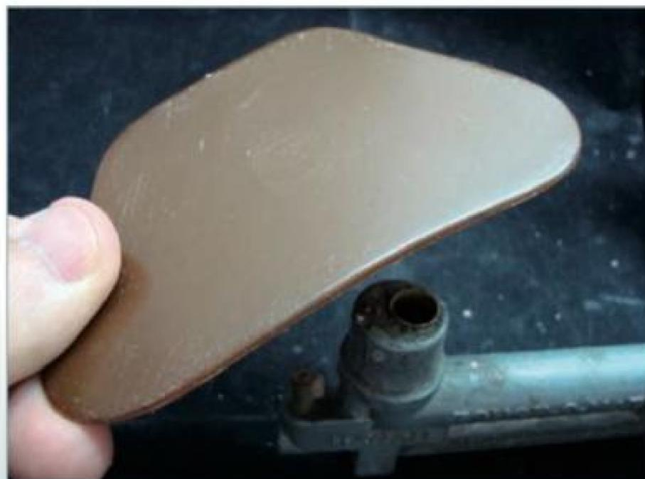
**Fig. 9-21.** Plastifica-se, sobre a chama, a placa de monoalbase, para facilitar o recorte.
