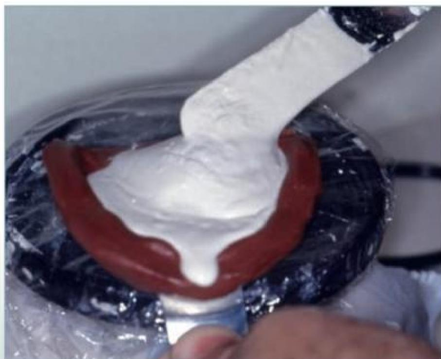
**Fig. 9-1.** Há quem prefira vazar o molde preliminar em godiva usando o vibrador.
