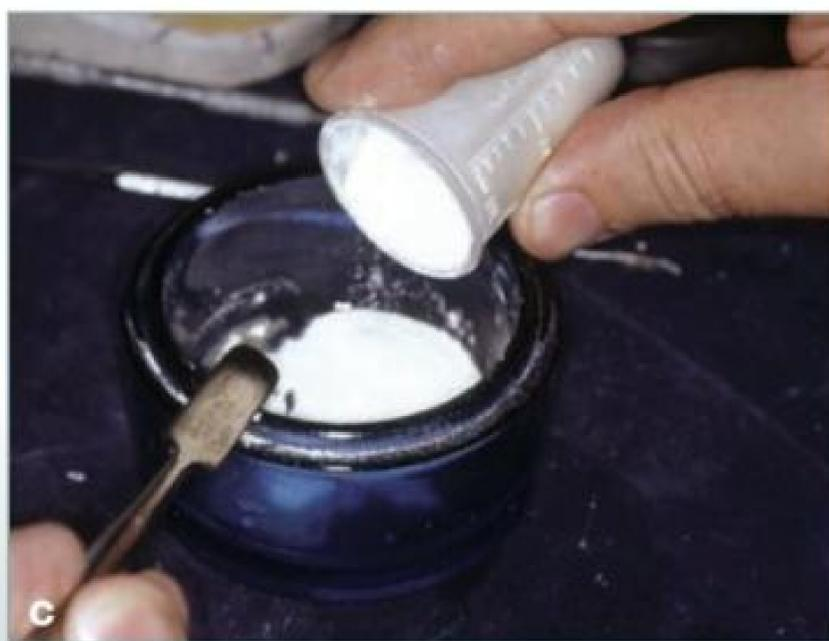
**Figs. 9-25a-c.** Sequência de preparo da resina acrílica, na proporção indicada pelo fabricante (4ª fase). Inicialmente, parece que o polímero não englobou totalmente o monômero, mas não se deve adicionar mais monômero e, sim, aguardar de três a quatro minutos, dependendo da temperatura ambiente.
