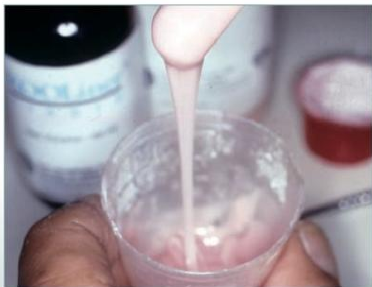
Fig. 27-54. Proporcionada a resina, a consistência ideal é quando escoar e está pastosa.
