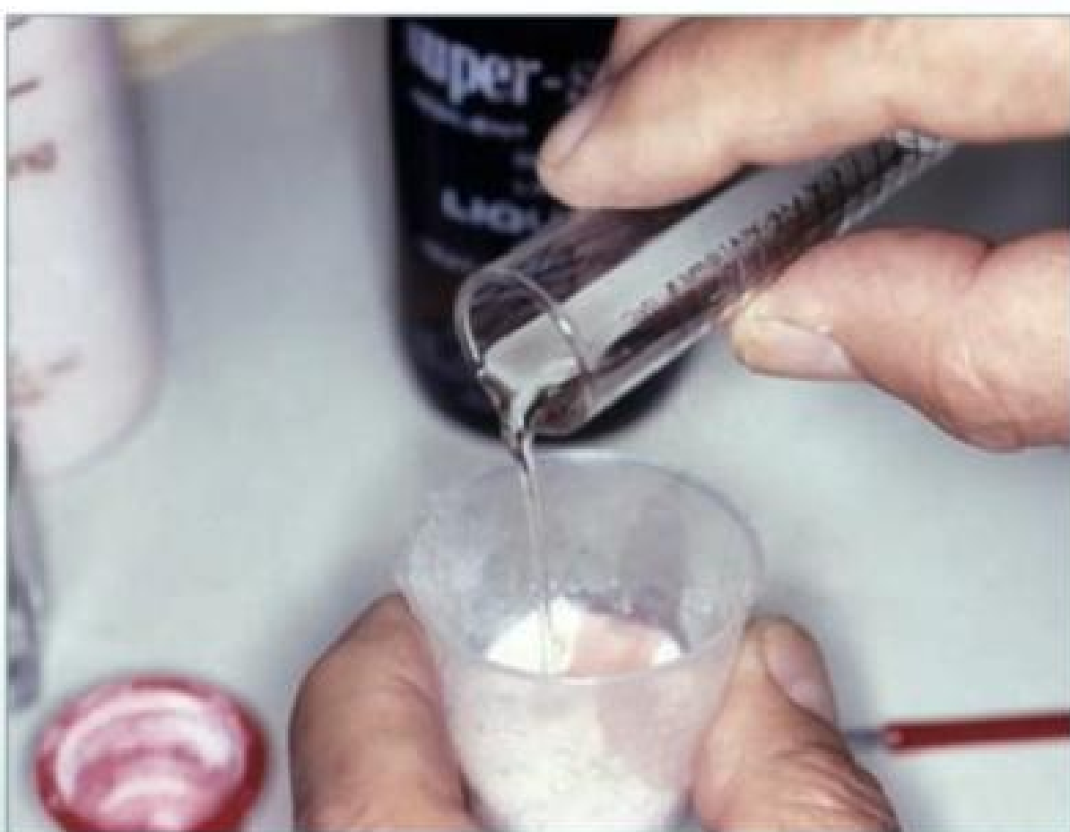
Fig. 27-38. Para uma medida de polímero, usa-se de 3 a 4 cc de monômero (o medidor faz parte do conjunto da Coe Dental).
