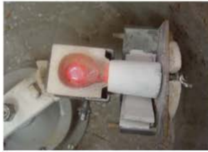
Figura 8.12 – Aspecto da liga fundida imediatamente antes da sua injeção para o cilindro de revestimento.
