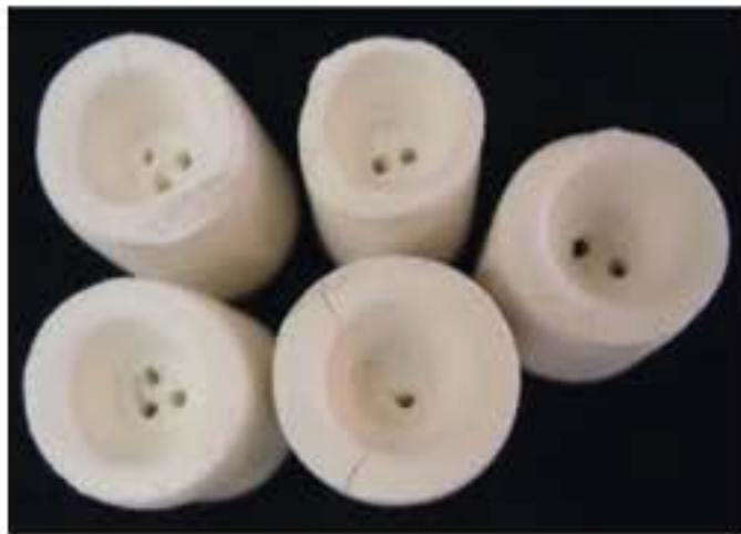
Figura 8.8 – Revestimentos solidificados mostrando os espaços pelos quais o metal irá fluir.
