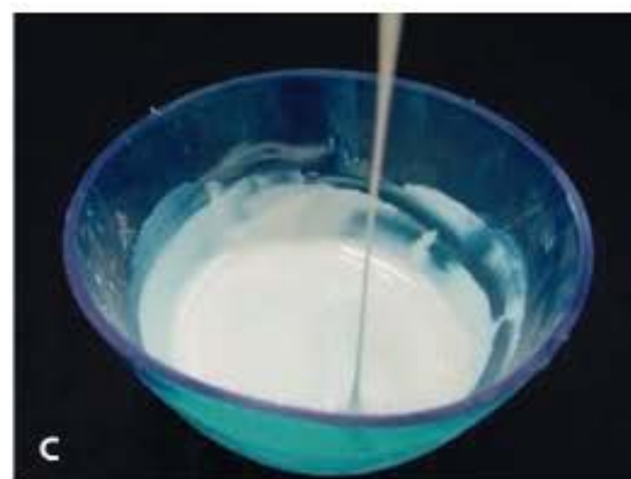
Figura 8.7 - Sequência ilustrando um revestimento (A), o início de sua mistura em um gral de borracha (B), a consistência fluida ideal desse revestimento (C) e o início do preenchimento do anel (D).
