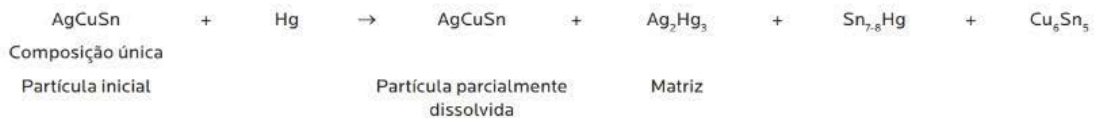
Figura 6.5 – Reação de presa – Fases metalúrgicas do amálgama, ligas com alto conteúdo de cobre – tipo composição única.
