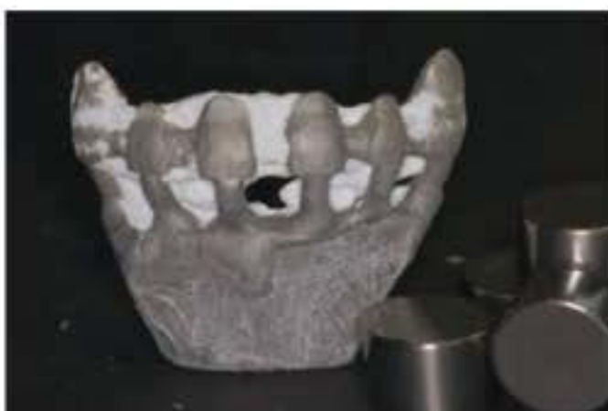
Figura 8.15 – Peça fundida ainda no processo de limpeza, o qual pode ser feito também por decapagem.
