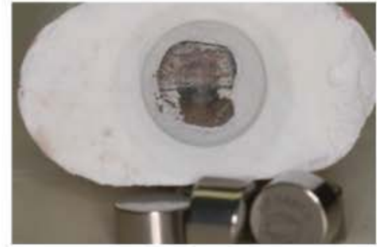
Figura 8.13 – Liga injetada no corpo do revestimento após resfriamento.
