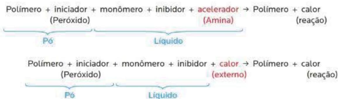
Figura 4.1 – Representação esquemática da reação de polimerização das resinas acrílicas ativadas química e termicamente.
