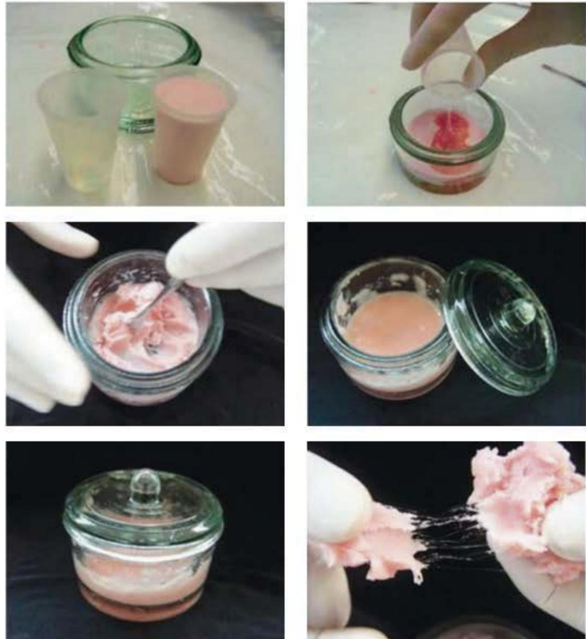
Figura 4.5 – Manipulação da resina acrílica.
