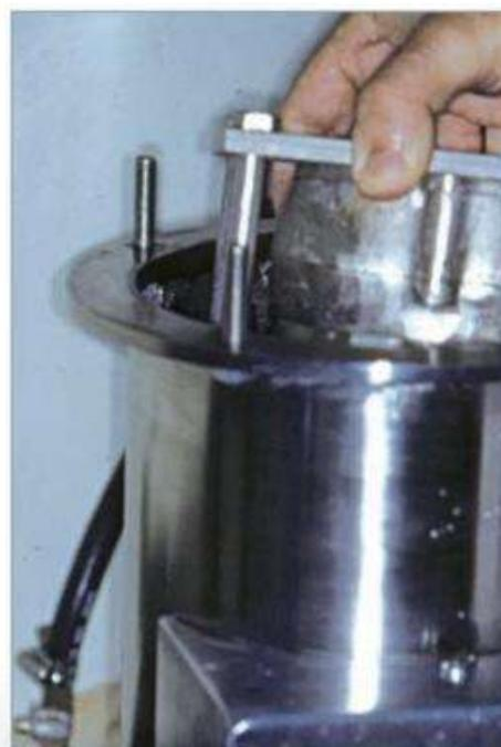
**Fig. 21-19.** Muflas prensadas com a placa Geton sendo imersas na panela de pressão.
