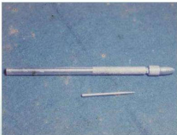
**Fig. 23-10.** Uma broca usada pode ser transformada em um bisel para ser montada na ponta-morse.
