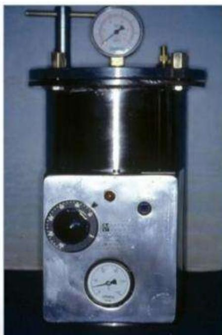
**Fig. 21-18.** Polimerizadora termopneumo-hidráulica. Notar na parte inferior o termômetro e o reostato; na tampa, o bico injetor de ar e o manômetro.
