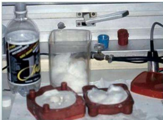
**Fig. 21-5.** Algodão embebido em água e removedor, para a retirada do excedente de cera.
