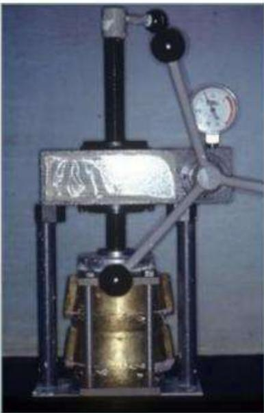
**Fig. 21-13.** Prensagem final com placas Geton em prensa hidráulica com pressão de 1,250 kg.
